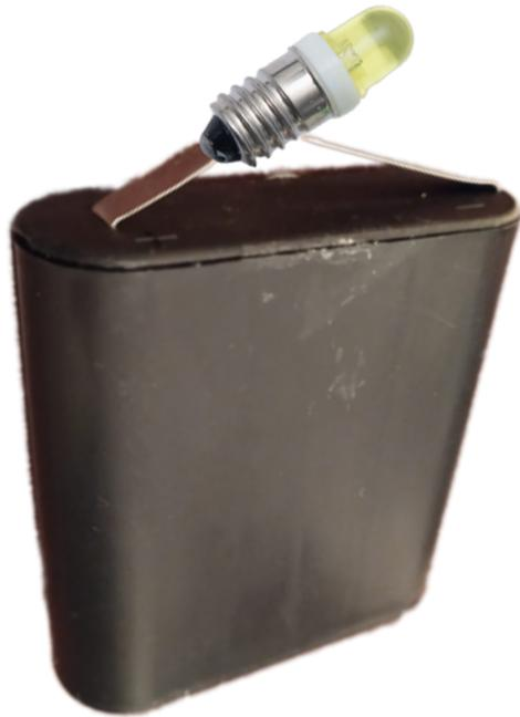
Wie du selbst herausgefunden hast, leuchtet die LED nur, wenn sie mit beiden Polen der Batterie verbunden ist.
