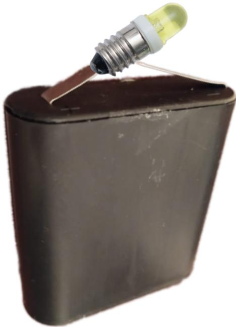
Wie du selbst herausgefunden hast, leuchtet die LED nur, wenn sie mit beiden Polen der Batterie verbunden ist.
