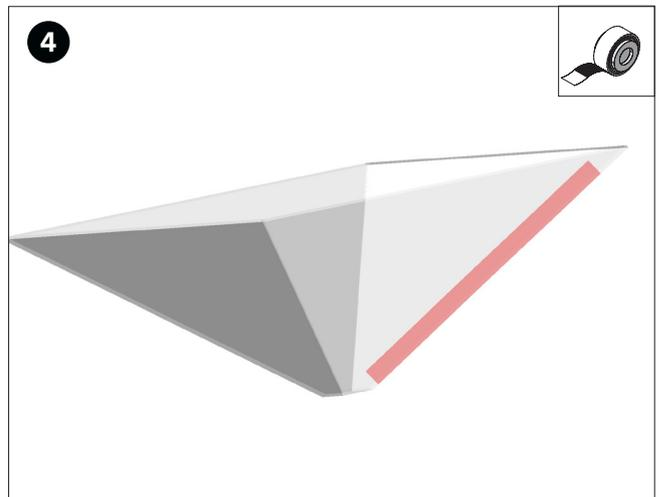
Doblar los cuatro segmentos hacia dentro, para darle forma de prisma. Fijar los bordes con la cinta autoadhesiva..
