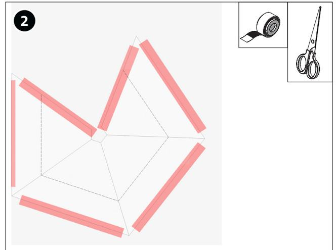
Fijar la plantilla (en la imagen modelo para Tablet) con cinta autoadhesiva sobre la lámina y recortarla.
