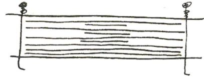
Puede poner una madera con peso encima sobre la pila de las hojas, y poner sargentos entre esta madera y la parte inferior sobre la cual se aguanta la pila de hojas (que puede ser otra madera) para presionar el agua hacia afuera. Después del presionado, puede pasar las hojas una por una a nuevos fieltros para ir secando. Mientras más a menudo se repita esta operación, más rápidamente se secarán los papeles.
