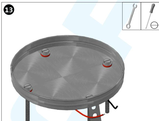
Nun werden die vier Schrauben und Muttern so fest angezogen dass die Schlauchstücke zu einer Dichtung zusammengepreßt werden. Die entstandene Schale mit etwas Wasser auf Dichtheit prüfen.
