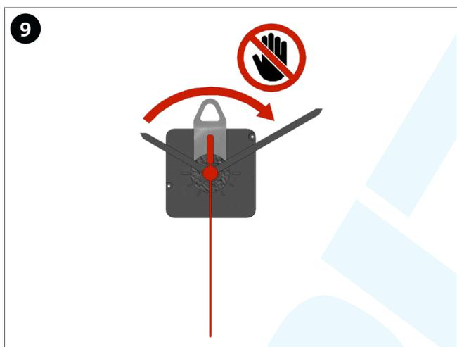
Le mouvement commence la synchronisation avec l'émetteur DCF77. Les aiguilles font quelques tours, restent immobiles pendant un moment puis s'ajustent à l'heure correcte après un certain temps. Ne déplacez pas et n'arrêtez pas le pointeur à la main pendant ce temps !
