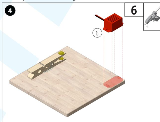
Den Summer (6) mit 2 Heißkleber-Punkten unter den Laschen auf die Platte kleben, Kabel in Richtung Wäscheklammer.
