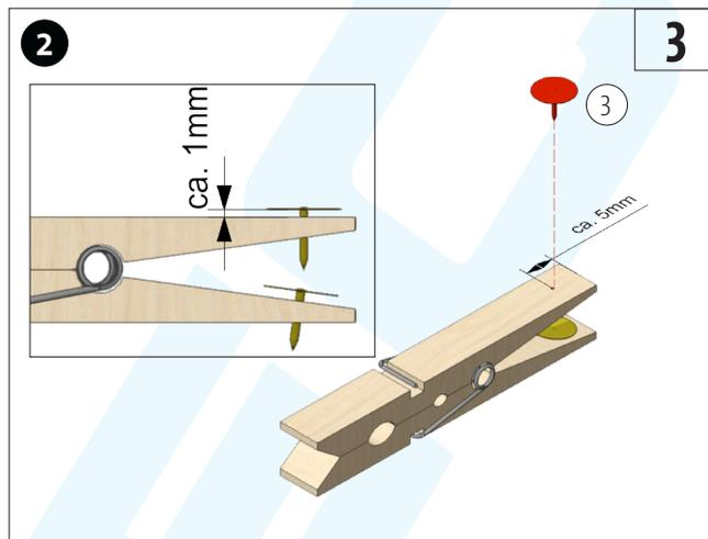
Den zweiten Reißnagel (3) wie im Bild in den oberen Wäscheklammerschenkel eindrücken. Beide Reißnägelnicht komplett eindrücken, hier werden später die Kabel heringewickelt.
