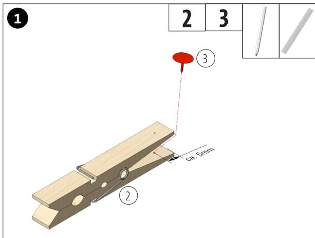
Schaltermontage: Einen Reißnagel (3) wie abgebildet in den unteren Wäscheklammerschenkel eindrücken
