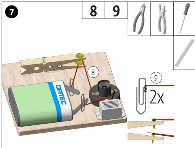
3x 150mm Schaltlitze ablängen, beidseitig ca. 20mm abisolieren. Wie im Bild jeweils verdrehen und verkabeln, siehe auch Schaltplan im nächsten Bild.
