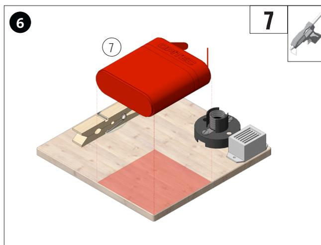
Flachbatterie (7) in die rechte untere Ecke kleben, kurzes Fähnchen nach links (Pluspol).
