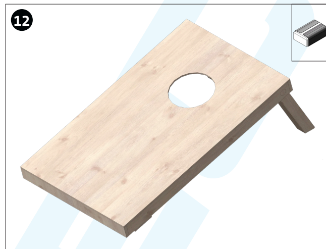
Anschließend alles sauber verschleifen sowie den Standfuß nochmals auf freie Beweglichkeit prüfen.
