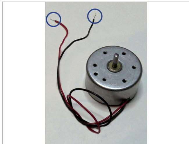
Die Enden der Motorkabel sind abisoliert. Du siehst das blanke Metall der Leitung, an der die Isolation fehlt. Dieses Metallstück muss eine elektrische Verbindung zu den Laschen der Solarzelle haben.
