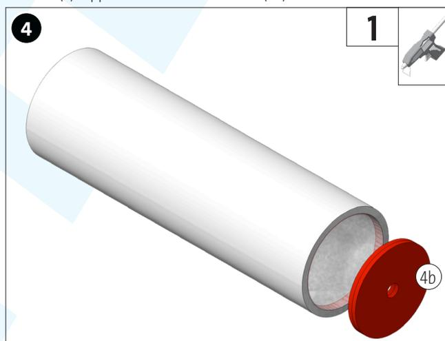
Incollare le ruote di cartone incollate (4b) a un'estremità del tubo di carta dura (1) a filo del bordo esterno.
