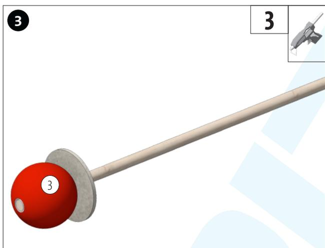
Rivestire il bastoncino rotondo con la colla a caldo. Quindi fissare la pallina di legno. Lavorare rapidamente per evitare che la colla a caldo si raffreddi.
