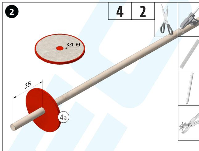
Tagliare circa 1 mm su tutto il perimetro della ruota di cartone rimanente (4). Allargare il foro a  $\varnothing 6$  mm. Misurare 35 mm a un'estremità del tondino (2). Applicare la ruota di cartone (4a) e incollarla.
