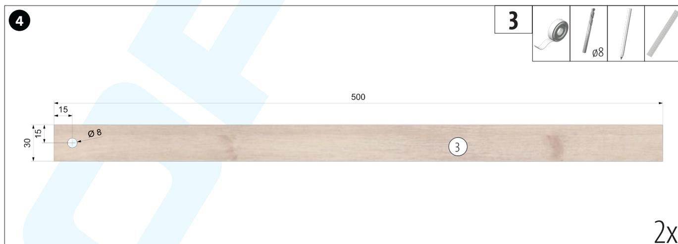
Misurare e segnare la posizione del foro sui listelli del telaio (3) come mostrato nell'illustrazione. Quindi forare con  $\varnothing 8$  mm.
