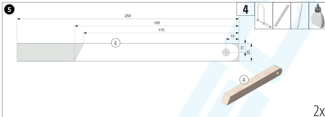
Tagliare le due gambe di supporto (4) a misura delle dimensioni. Misurare e segnare la posizione del foro. Praticare quindi un foro di  $\varnothing 8$  mm. Pulire i tagli della sega.
