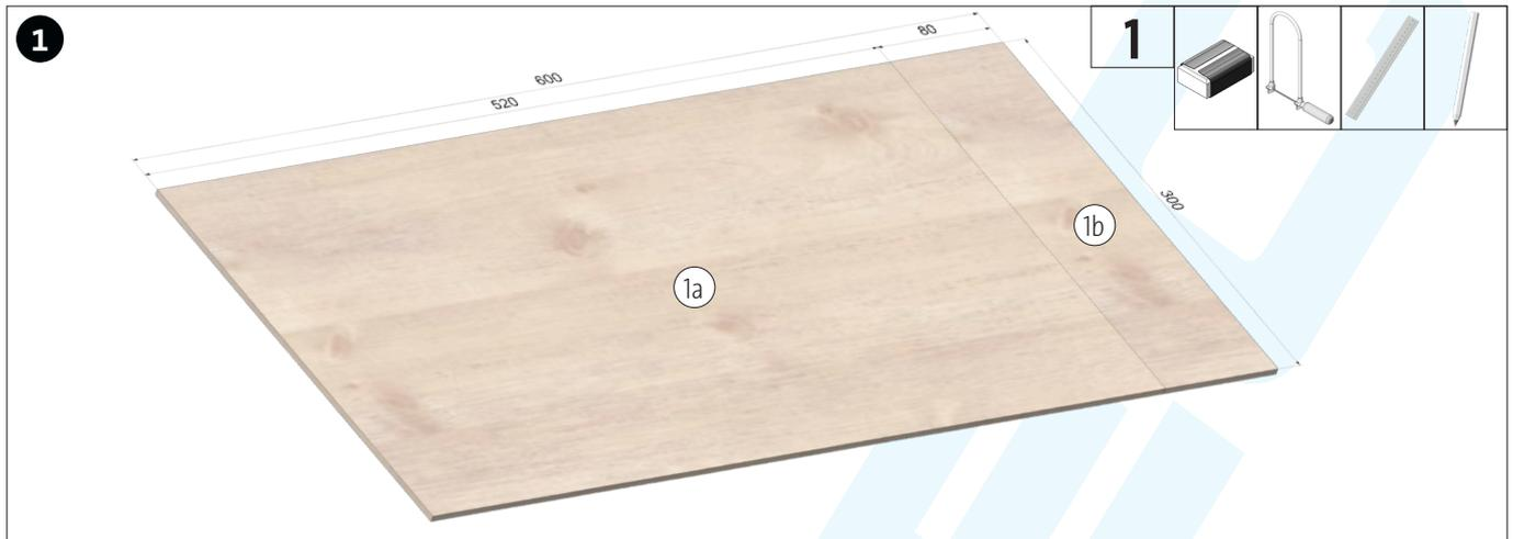
Die Grundplatte (1), wie abgebildet, mit der Laubsäge in zwei Teile (1a/1b) teilen. Anschließend Sägeschnitte säubern.
