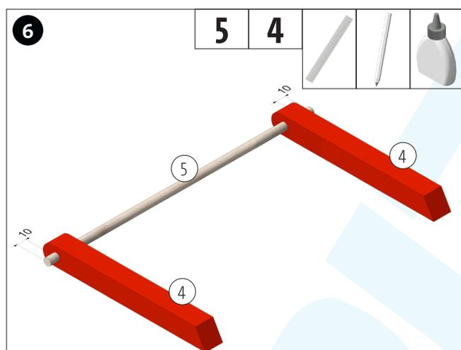
Die beiden Standfüße (4), wie abgebildet deckungsgleich auf den Rundstab (5) aufleimen. Leim gut trocknen lassen.
