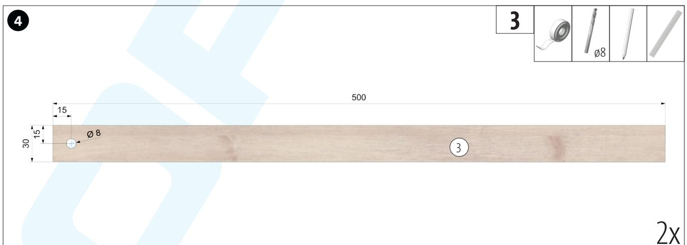
Auf den Rahmenleisten (3) die Position für die Bohrung, gemäß Abbildung, abmessen und markieren. Anschließend  $\varnothing 8$  mm durchbohren.
