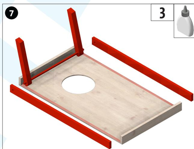
Anschließend die beiden Seitenleisten (3) aufleimen und hierbei den Rundstab mit den Standfüßen dazwischen in den Bohrungen  $\varnothing 8\text{mm}$  platzieren. Leim gut trocknen lassen.
