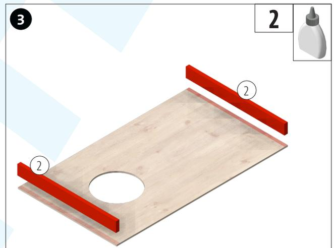
Die beiden Stirnleisten (2) wie abgebildet auf der Deckplatte aufleimen
