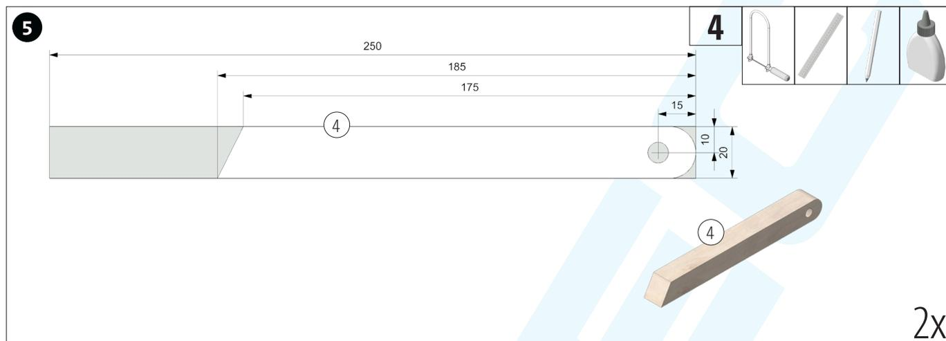
Die beiden Standfüße (4) nach Bemaßung ablängen. Die Position der Bohrung abmessen und markieren. Anschließend  $\varnothing 8\text{mm}$  durchbohren. Sägeschnitte säubern.
