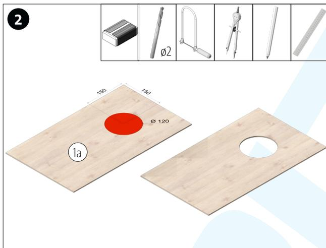
Auf der Deckplatte (1a) die Position des Wurfloches anzeichnen, aus-sägen und Sägeschnitt säubern.
