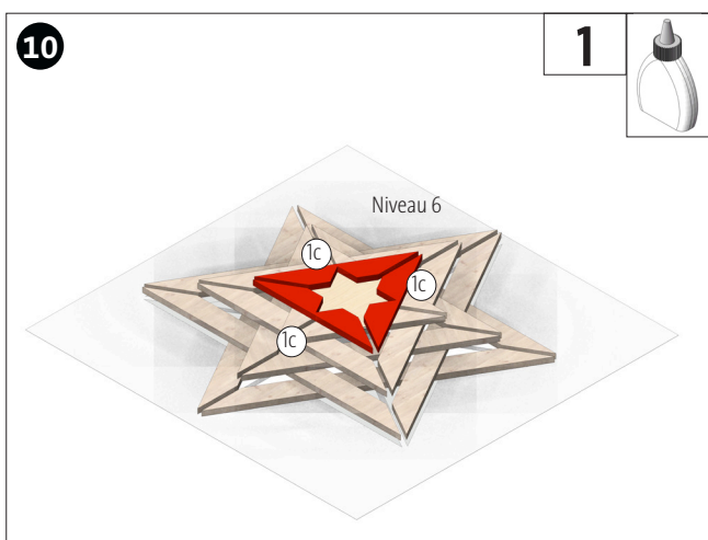
Niveau 6 van drie houten latten (1c) volgens het sjabloon verlijmen. Voor de 2e ster helft, stap 3-10 herhalen.
