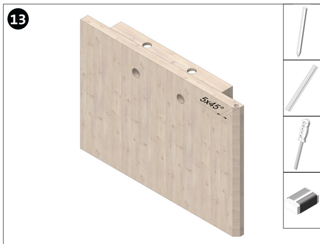
Biselar el contrachapado como se muestra en la imagen.
