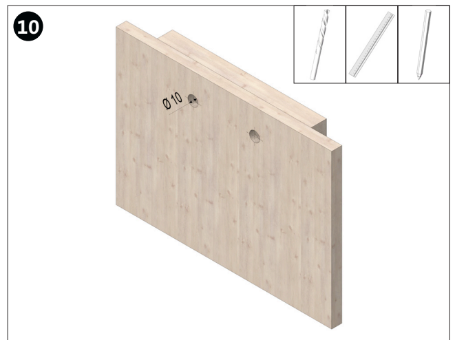
Die Bohrungen von vorne aufbohren.
