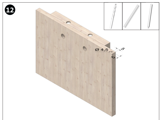
Die Maße auf das Sperrholz übertragen. Das Sperrholz, wie abgebildet, von oben und von unten 20 mm tief bohren.
