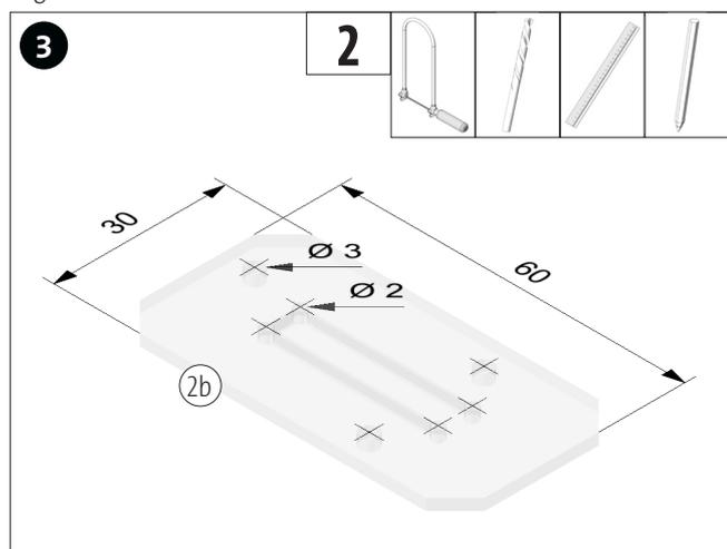
Schablone (C) ausschneiden und auf das Acrylglas (2) übertragen. Das Acrylglas, wie abgebildet, bohren sägen und anfasen. Anschließend das Sägeblatt durch die Bohrung  $\varnothing 2$  mm fädeln und die Lasche sägen.
