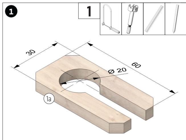
Schablone (A) ausschneiden und auf das Sperrholz (1) übertragen. Das Sperrholz anschließend, wie abgebildet, bohren, sägen und anfasen. Sägeschnitte säubern.
