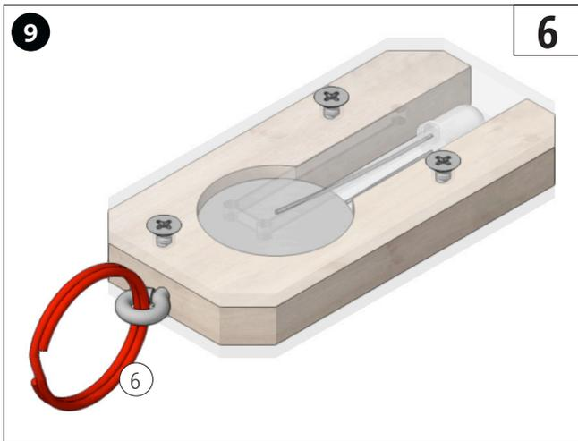
Den Schlüsselring (6) in die Ringschraube eindrehen.
