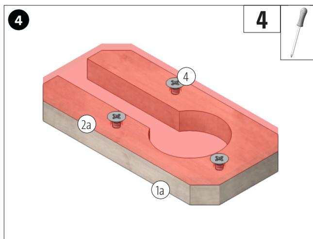
Das Acrylglas (2a) mit den Senkkopfschrauben (4) auf die Sperrholzplatte (1a) aufschrauben.
