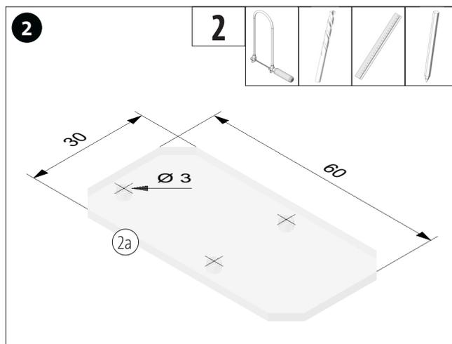
Die Schablone (B) ausschneiden und auf das Acrylglas (2) übertragen. Das Acrylglas anschließend bohren, sägen und anfasen.
