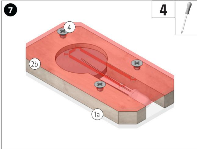
Das Acrylglas (2a), wie abgebildet, mit den Senkkopfschrauben (4) auf die Sperrholzplatte (1a) aufschrauben.
