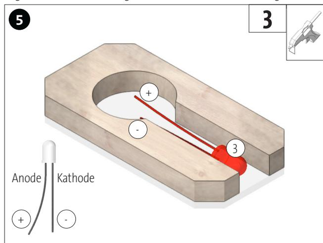
Die LED (3), wie abgebildet, aufbiegen und mit der abgeflachten Seite bzw. der Kathode (-) nach unten aufkleben.
