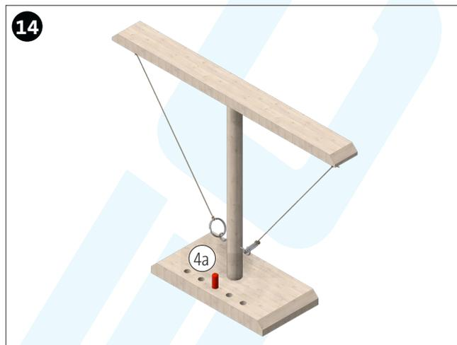
Den Holzrundstab (4a) in die mittlere Bohrung stecken.
