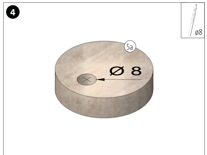
Het gat met \varnothing 8 mm uitboren.
