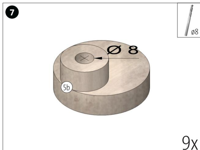
Praticare il foro ( $\varnothing 3$  mm) con  $\varnothing 8$  mm.
