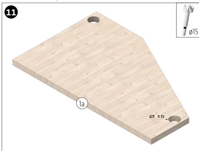
Die Bohrungen mit  $\varnothing 15$  mm aufbohren.
