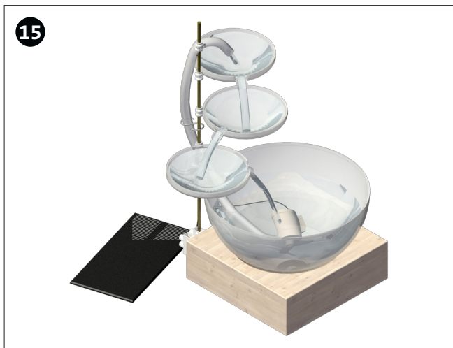
15 Sluit de zonnecel aan en plaats de fontein op een zonnige plek. Opmerking: De pompsterkte kan worden geregeld door afzonderlijke delen van de zonnecel af te dekken..
