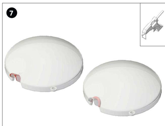
Encolar los trozos de tubo de PVC como se muestra en la imagen al desagüe del cuenco con la pistola termoencoladora. Reforzar desde abajo con un cordón de cola.
