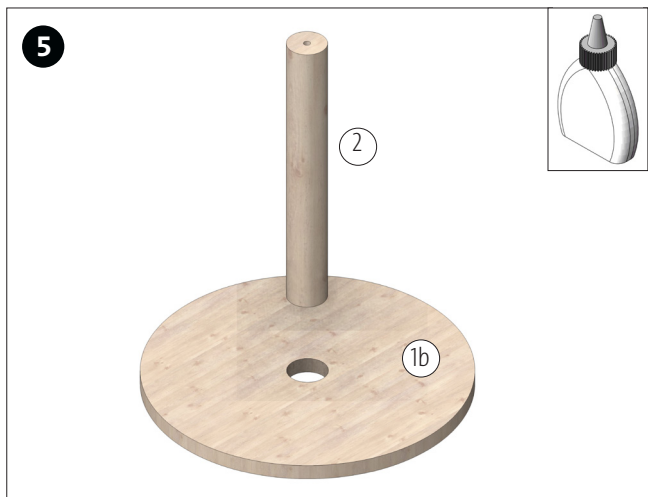
Den Rundstab (2) mit der 8 mm Bohrung nach unten, bündig zur Unterkante, in die Mittelronde (1b) einleimen
