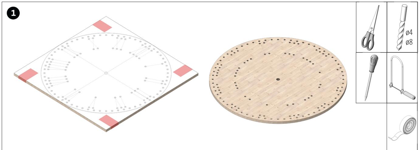
Die Schablone (Seite....) ausschneiden und zusammen kleben. Die Schablone auf die Grundplatte (1) aufkleben. Anschließend die Bohrungen mit dem Vorstecher markieren. Alle Bohrungen  $\varnothing 4, \varnothing 8$  mm durchbohren. Rinde aussägen und Sägeschnitte säubern.
