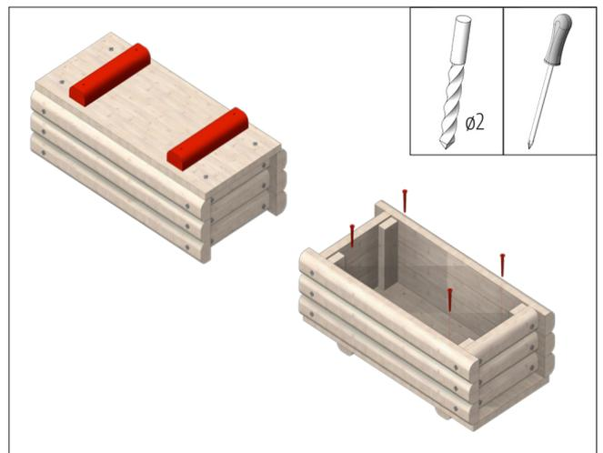
Pretaladrar orificios de  $\varnothing 2$  mm la placa base a través de los orificios de los listones de la base. Para terminar, asegurar con los 4 tornillos (5).
