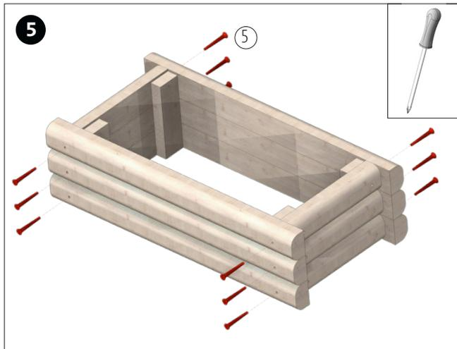
Asegurar las paredes con los tornillos (5) como se muestra en la imagen.
