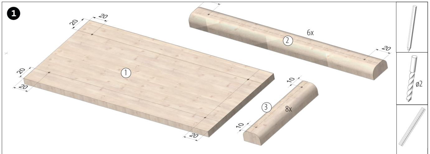
Marcar la posición de los orificios en la placa base (1) y en los listones redondeados (2+3) y hacer las perforaciones de  $\varnothing$  2mm.
