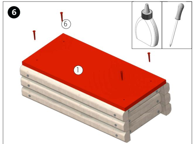
Encolar la placa base (1) y terminar de asegurar con los tornillos (6).
