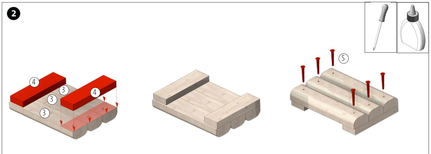
Encolar 3 listones de madera redondeados (3) y 2 listones (2) para formar un lateral. Fijar con 6 tornillos (5). Repetir con los 3 listones redondeados con orificio (3) y los otros 2 listones (4) restantes.
