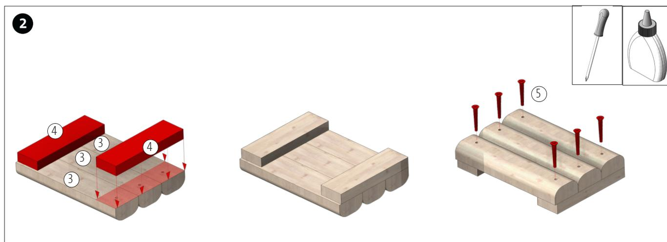
Jeweils 3 Profilholzleisten (3) und 2 Holzleisten (4), wie abgebildet, zu einer Seitenwand verleimen. Anschließend mit den 6 Schrauben (5) fixieren. Das Ganze mit den übrigen 3 gebohrten Profilholzleisten (3) sowie 2 Holzleisten (4) wiederholen.
