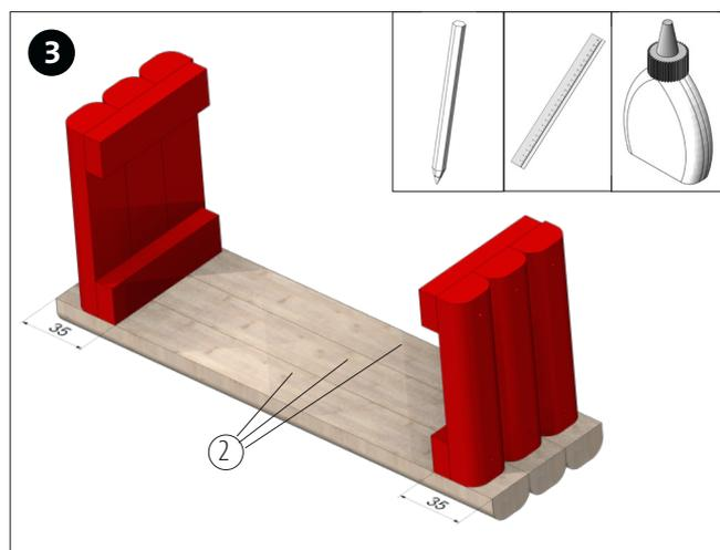
Die beiden Seitenteile, wie abgebildet, mit 3 Profilholzleisten (2) verleimen. **Hinweis:** Position vor dem Verleimen abmessen und markieren.
