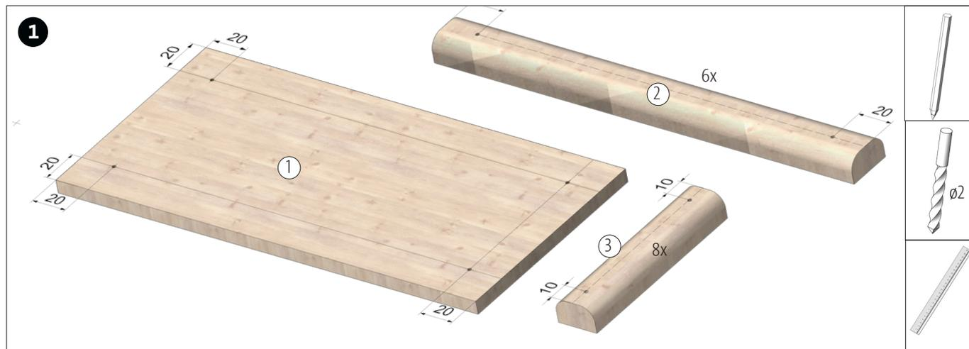
Auf dem Holzbrett (1) sowie den Profilholzleisten (2+3) die Position der Bohrungen anzeichnen und  $\varnothing 2$  mm durchbohren.
