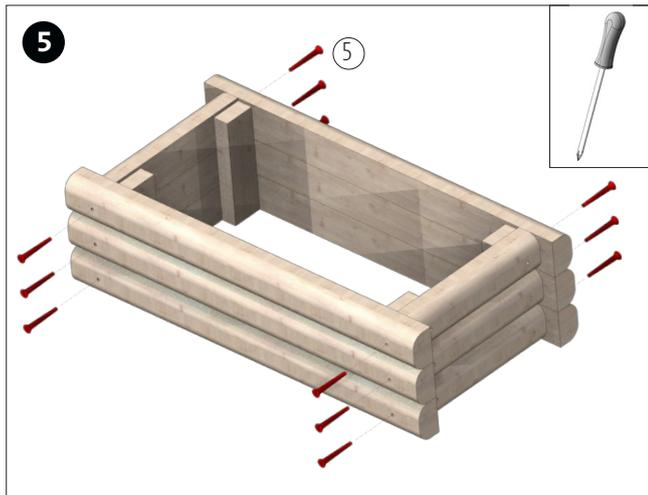
Die Wände mit den Schrauben (5), wie abgebildet, endfixieren.
