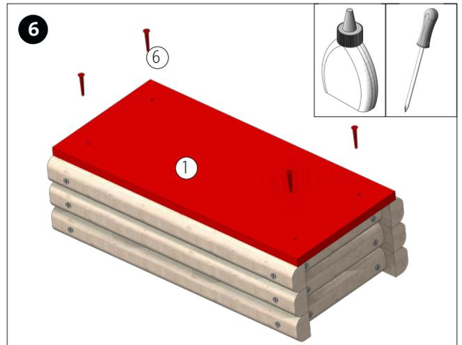
Die Bodenplatte (1) aufleimen und mit den Schrauben (6) fixieren.
