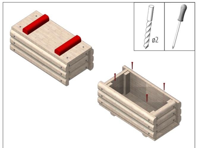
Die Bodenplatte durch die Bohrungen in den Fußleisten  $\varnothing 2$  mm vorbohren. Anschließend mit den restlichen 4 Schrauben (5) fixieren.
