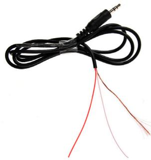
Prima di eseguire la saldatura fare un nodo nel cavetto per poter proteggerlo da eventuali strappi a tiro!
