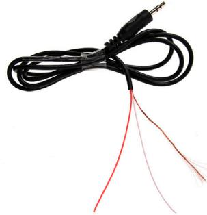
7. Das abisolierte Ende des Kabels durch das vorgebohrte Loch in der Holzleiste stecken und das weiße Kabel am rechten Anschluss (+) des linken Lautsprechers anlöten. Das rote Kabel am rechten Anschluss (+) des rechten Lautsprechers anlöten. Vom Schalt-Y-Draht 2 ca. 50mm lange Stücke abschneiden und die Enden beider Schaltdrahtstücke ca. 5mm abisolieren.
