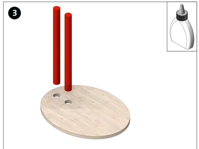
Die beiden Rundstäbe, wie abgebildet, in die Bohrungen der ersten Ellipse einleimen. Leim gut trocknen lassen.
