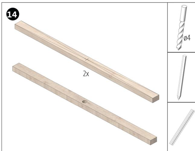
Marcar el centro de los dos listones restantes y realizar un orificio de  $\varnothing 4$  mm.
