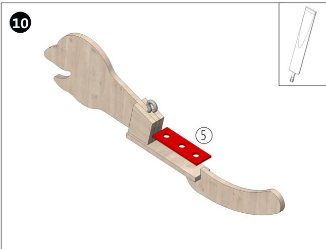
Um das Gleichgewicht des Kopfes im Korpus herzustellen, reicht bei genauer Sägearbeit ein Gewicht aus. Dieses wie abgebildet mit Alleskleber aufkleben. Sollte dies nicht der Fall sein, wird nach vorheriger Prüfung ein zweites Gewicht aufgeklebt.
