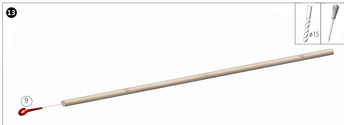
Avec la tige ronde restante (3), marquer le point central avec le poinçon (éventuellement pré-percer  $\varnothing 1,5$  mm) et visser les crochets à pas de vis restants (9).
