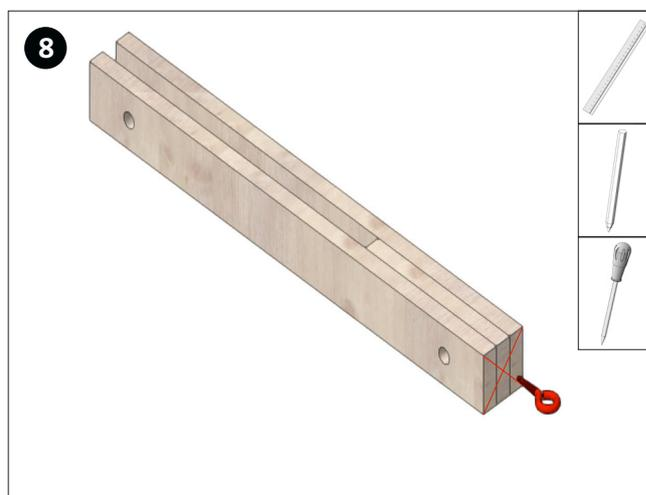
Determinare il punto centrale sul lato anteriore utilizzando le diagonali. Preforare questo punto e poi avvitare un golfare (14) in modo che l'apertura sia perpendicolare alle modanature (vedi figura).
