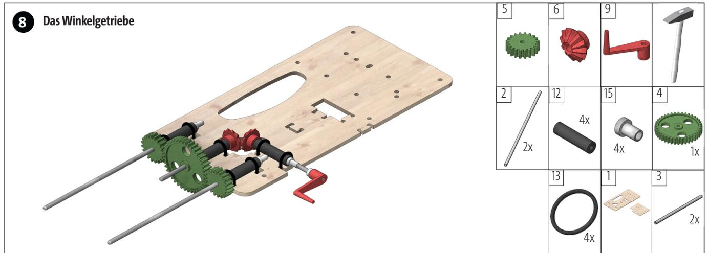
Wie das Schneckengetriebe ändert das Winkelgetriebe auch die Richtung der Wellen um 90 Grad. Im Gegensatz zum Schneckengetriebe sind beim Winkelgetriebe aber kleine Übersetzungen möglich. Meist verwendet ist 1:1. Anwendungsbeispiel : Betätigungsgetriebe von Oberlichtern.
