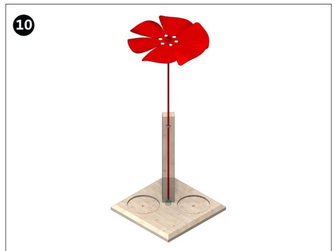
Placez le rotor sur la tige à travers des pitons à vis sur le support en verre (cf. illustrations).
