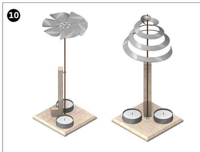
Placez une bougie chauffe-plat dans chacun des renforcements et allumez-le. Le rotor tourne!
