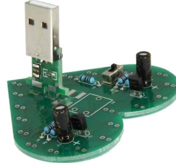
**G** Después de elegir la ubicación correcta, suelde el conector USB. En primer lugar, suelde ligeramente una sola unión soldada y, a continuación, alinee el enchufe USB. (si es en ángulo) y luego soldar en las 3 uniones soldadas restantes. Sólo si las 4 uniones soldadas están soldadas, se garantiza una buena estabilidad del enchufe USB.
