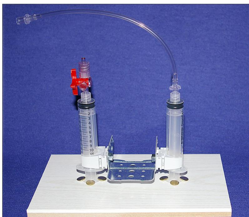
Place la fiche de raccordement restante à l'une des extrémités du second tuyau, puis le raccord à vis à l'autre extrémité. Teste le tuyau pour vérifier que les connexions sont bien faites.
