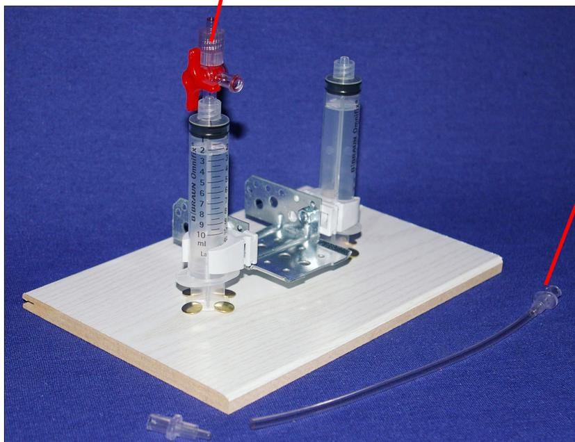
Place une **fiche de raccordement** à chacune des deux extrémités d'un tuyau. (Attention: ne pas confondre "fiches de raccordement" et "raccord à vis"!).
