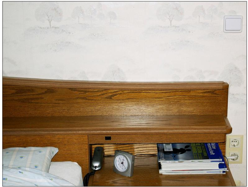
Dans une chambre à coucher, il y a un **interrupteur** à côté de la porte et un autre à côté du lit. Avec n'importe lequel de ces deux interrupteurs, on peut allumer et éteindre la lumière de manière indépendante.
