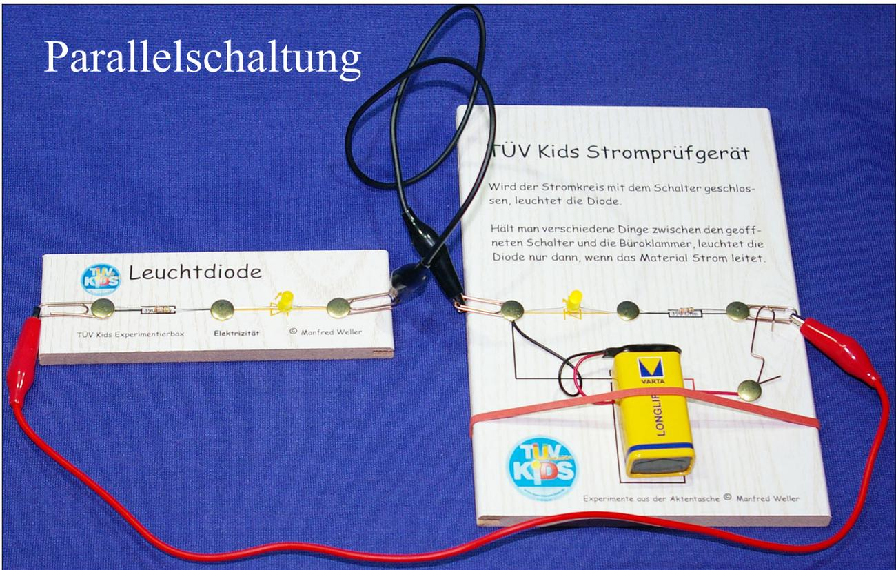
Nutze das TÜV Kids Stromprüfgerät als Stromquelle. Mit Messstrippen kannst du deine Leuchtdioden anschließen.
