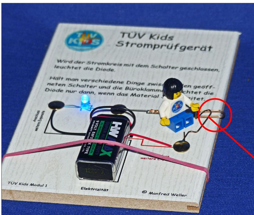
Collega la batteria e bloccala con un elastico.
