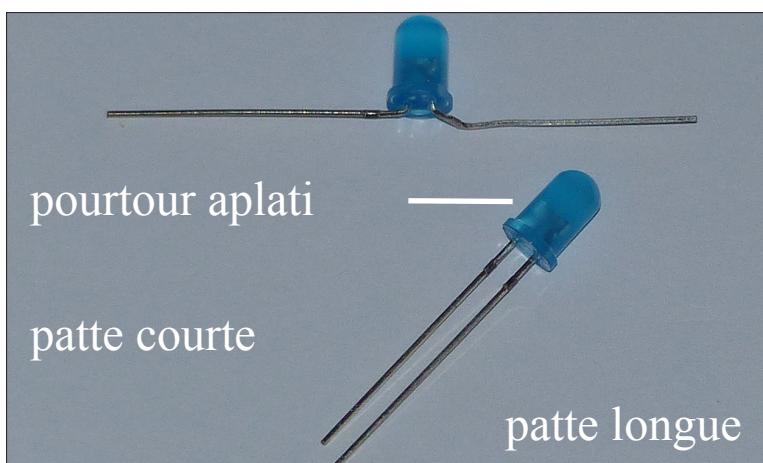
Les LED ne conduisent le courant électrique que dans une direction. Tu dois toujours connecter la patte courte au câble noir.
