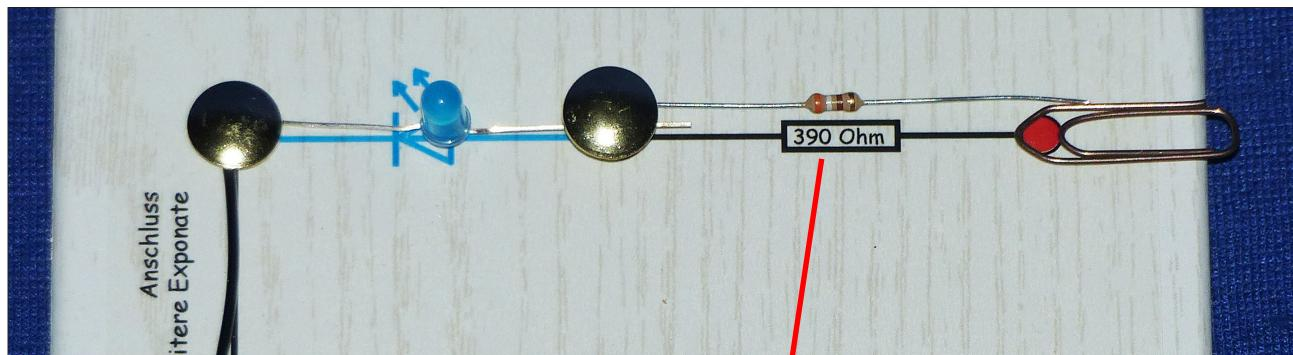
Si la LED est connectée à une pile de 9 volts, il faut placer une **résistance** électrique entre les deux. Sinon, la diode brûle.
