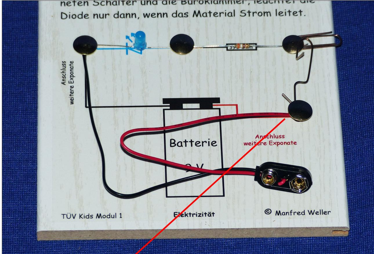
Place l'**extrémité dénudée** du câble rouge dans le trou déjà percé. Passe une punaise à travers l'oeillet de l'interrupteur puis enfonce-la de manière à ce que la pointe et le contact du câble rouge se touchent à l'intérieur du trou.
