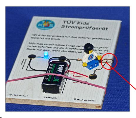
Schließe die Batterie an und sichere sie mit einem Gummiring auf dem Brett.
