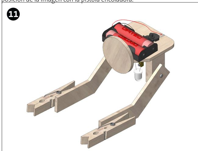
Para terminar, colocar las pilas y accionar el pulsador para comprobar que el LED se encienda.
