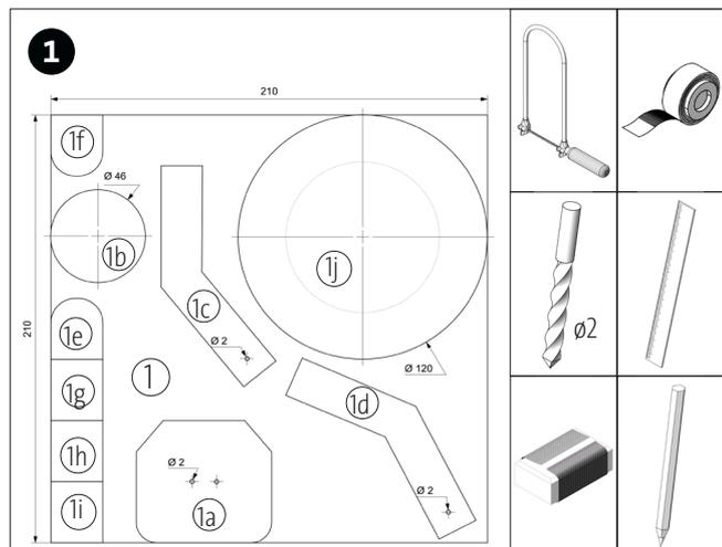
Riporta il modello delle singole parti (pag. 5) sul pannello di compensato (1). Pratica i fori Ø2mm, ritaglia tutte le parti con il seghetto da traforo, pulisci i residui di taglio.
