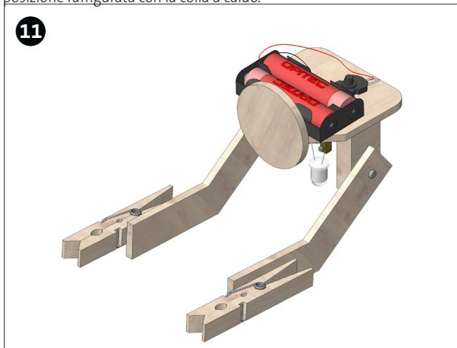
Inserisci le batterie e verifica il funzionamento del circuito azionando l'interruttore si deve accendere il LED.
