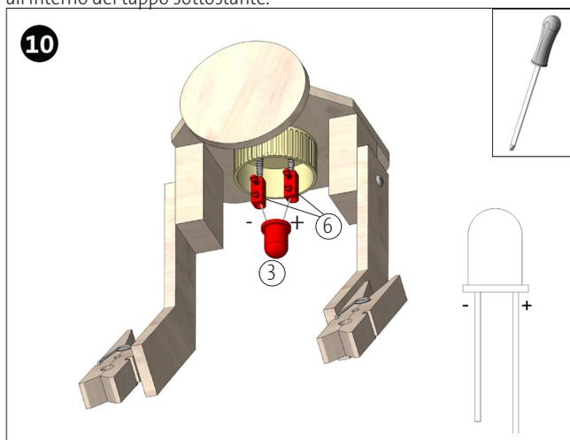
Blocca i connettori (6) sulla punta delle due viti all'interno del tappo. Inserisci le gambe del LED (3) e stringi le viti del connettore. Rispetta i poli!
