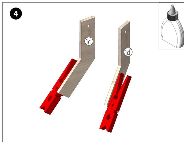
Die beiden Wäscheklammern (5) wie abgebildet auf die beiden Armteile (1c+1d) aufleimen.
