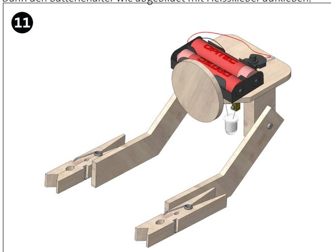
Anschließend Batterien einsetzen und die Funktion der Beleuchtung durch Betätigen des Schalters prüfen.
