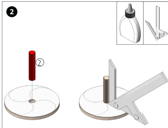
Colocar la espiga de madera (6) en el orificio del disco de madera (1) en ángulo recto y encolar. Dejar secar bien la cola. Atención! Utilizar una escuadra para asegurarse de que la espiga forma un ángulo recto con el disco.
