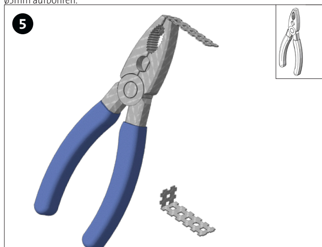
Die beiden Lochblechstreifen (2b) wie abgebildet mit der Kombizange gleichmäßig an der Biegekante 90° umbiegen.
