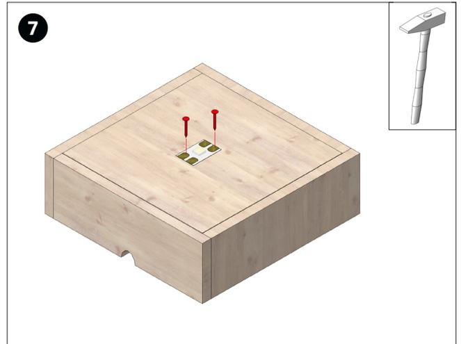
Einen Nagel (9) durch den Pluspol der LED (6) einschlagen. Einen zweiten Nagel (9) diagonal zum ersten Nagel am Minuspol der LED einschlagen.
