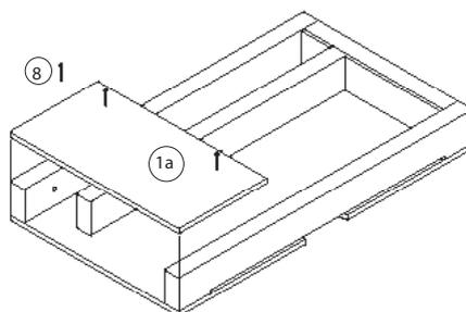
13. Appoggiare e avvitare il vetro acrilico (3) con le viti (7) a pari sulla superficie di compensato (1a).
