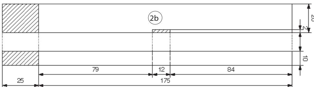
Appoggiare un listello (2) sul bordo stretto e tracciare i due angoli da  $45^\circ$ . Intagliare gli angoli da  $45^\circ$  di 2 mm e lavorare la rientranza a forma trapezoidale con una lima. Nota: Rispettare le dimensioni!
