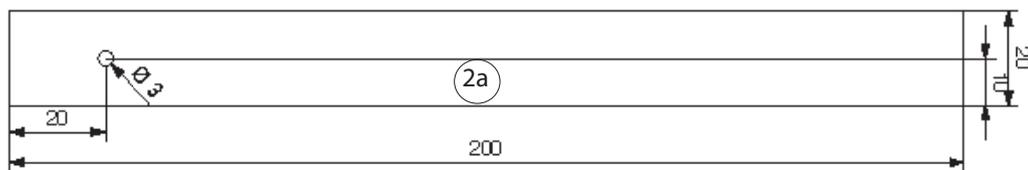
Accorciare un listello (2) di 25 mm e levigare le superfici di taglio. Successivamente eseguire una rientranza di 12 mm e 2 mm di profondità allo spigolo inferiore. La rientranza va eseguita tramite lima.
