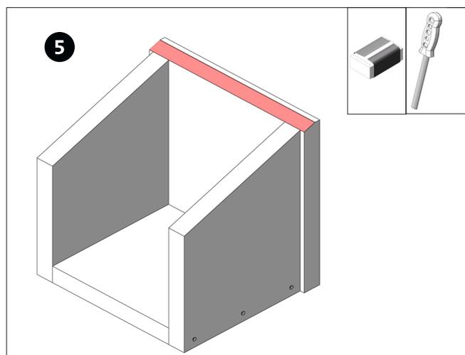
Limare con la lima per legno lo spigolo superiore della parete posteriore e poi livellarlo con la carta abrasiva.
