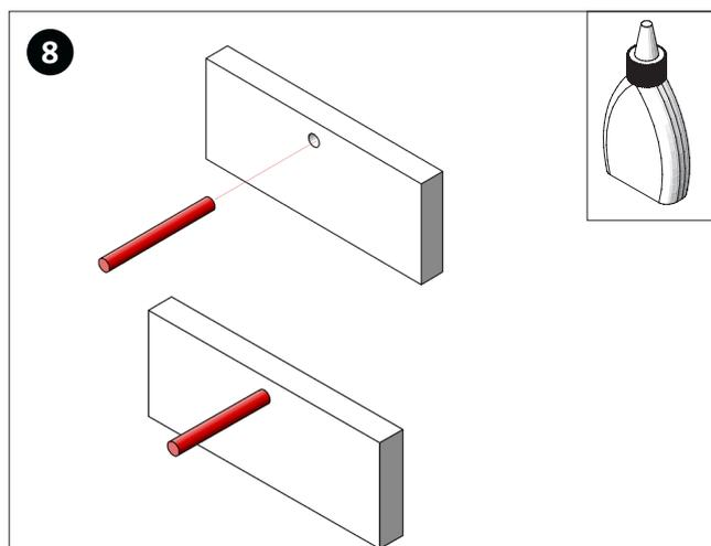
Incollare con la colla per il legno il tondello (6) nel foro (Ø10mm) della tavoletta di legno (2a).
