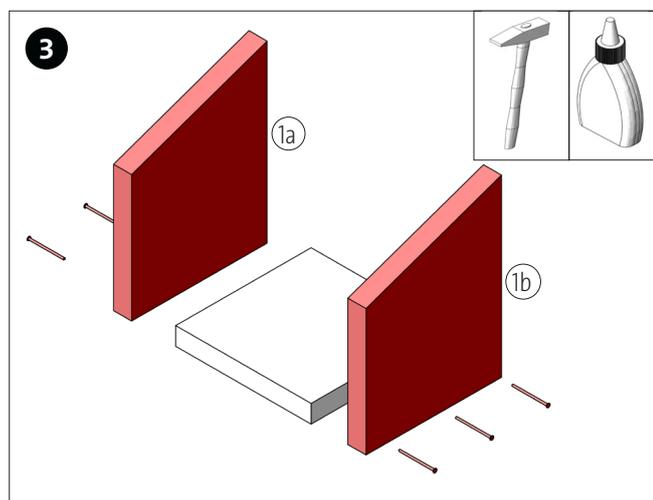
Fissare con la colla per legno entrambe le parti laterali (1a+1b) al piano di base (4) come illustrato e fissare anche con 3 chiodi (7) per parte.
