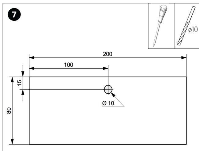
Marcare con una lesina sulla tavoletta di legno (2a) il foro da Ø10mm secondo misura e infine praticare il foro.
